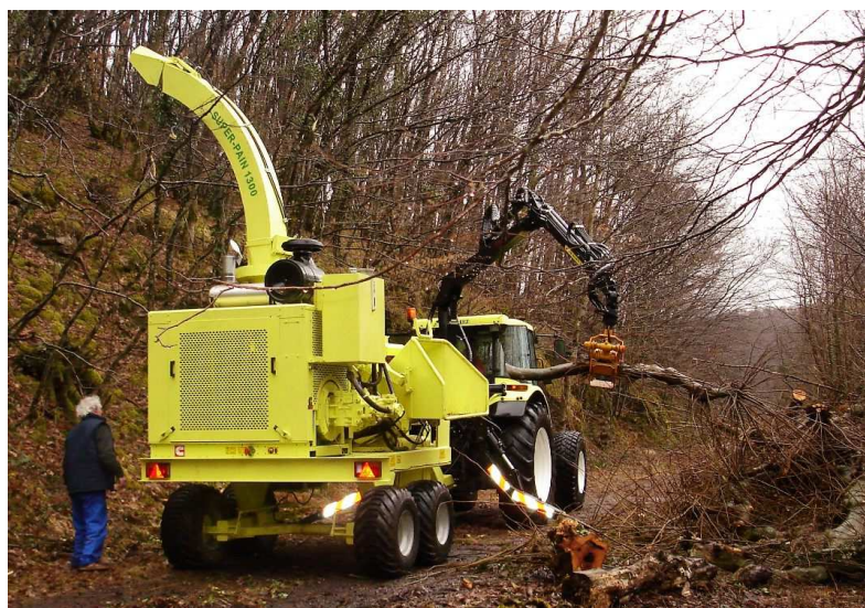
SP 1300, moteur CUMINS 250 cv, sur double essieu agricole
