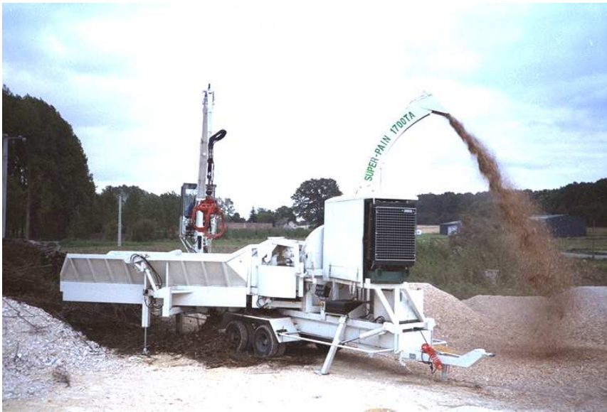
SP 1700TA, moteur VOLVO 320 cv, sur remorque routière
