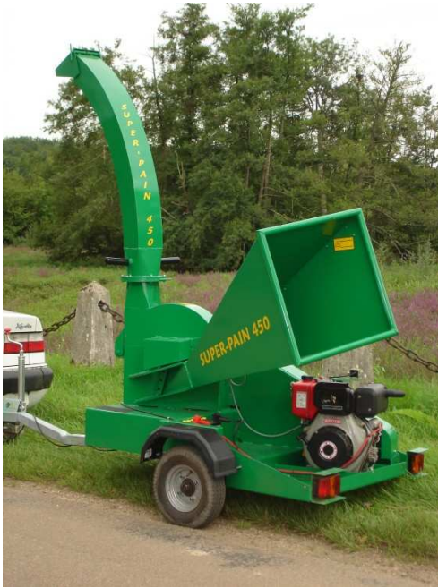
SP 450 avec goulotte d'élévation, moteur HONDA 13cv ess., sur remorque routière
