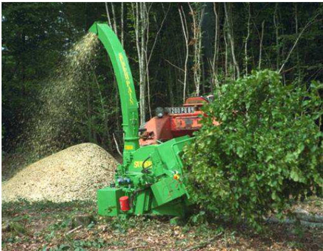
SP 900T avec entraîneurs hydrauliques
