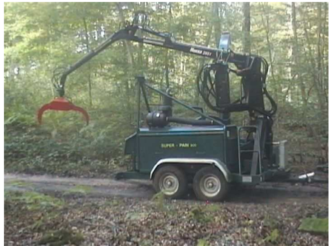
SP 900 avec entraîneurs hydrauliques, avec moteur thermique 150 cv, grue, sur remorque routière
